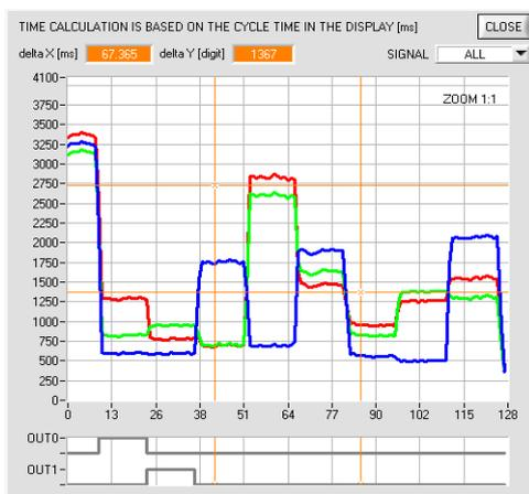
Durch Halten der Steuerungstaste Strg (CTRL) und Aufziehen eines Fensters mit der Maus im Graphen kann in den Graphen gezoomt werden.
