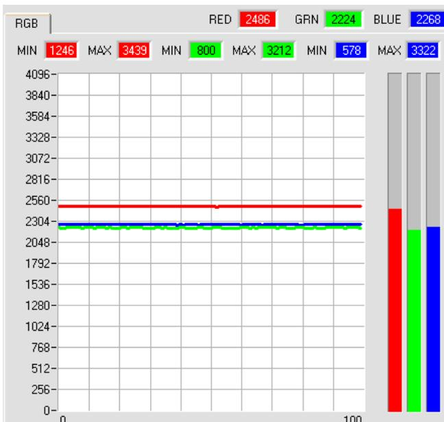
Wenn der rote Kanal größer wird als 2000, schaltet der Ausgang OUT0 auf HI. Ist er kleiner als 2000, schaltet er auf LO.
