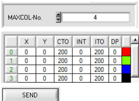
In diesem Beispiel wurde **MAXCOL-No.** = 4 ausgewählt, d.h., der Sensor soll die Farbinformationen wieder finden, welche in den ersten 4 Zeilen der **TEACH TABLE** durch externes Lernen über IN0 abgespeichert werden. Da sich der Sensor seine Toleranzen für den Farbkreis (**CTO**) und die Intensität (**ITO**) nicht selber berechnen kann, müssen diese Werte einmalig eingegeben werden (hier überall 200) und zusammen mit der **MAXCOL-No.** sowie **EXTEACH = ON** im **EEPROM** abgespeichert werden.
