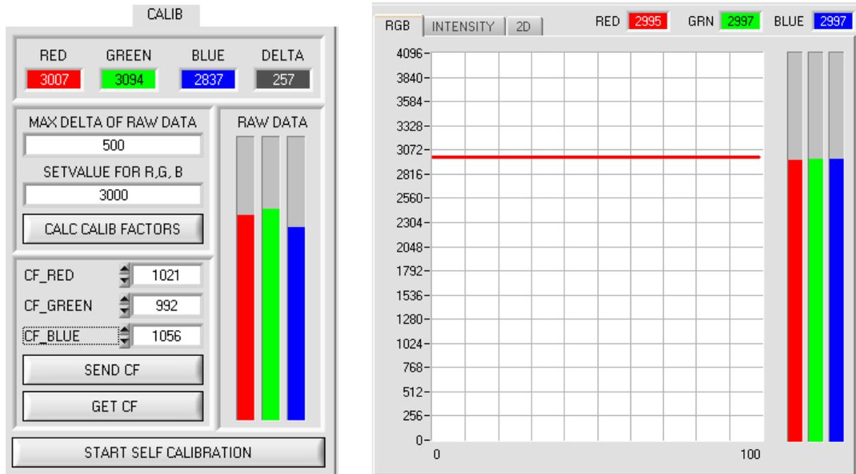
Nachdem die Kalibrierungsfaktoren von der Software auf der Benutzeroberfläche berechnet worden sind, werden sie automatisch in dem nichtflüchtigen Speicher **EEPROM** des Sensors abgelegt. Die Kalibrierung ist somit beendet und es kann im Hauptpanel weitergearbeitet werden.
